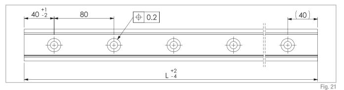
Туре Size Min length Max length Available standard lengths [mm] L [mm] [mm] TMGC 160 - 240 - 320 - 400 - 480 - 560 - 640 - 720 - 800 - 880 - 960 - 1040 160 18 2960 TMGV - 1120 - 1200 - 1280 - 1360 - 1440 - 1520 - 1600 - 1680 - 1760 - 1840 - 1920 - 2000 - 2080 - 2160 - 2240 - 2320 - 2400 - 2480 - 2560 - 2640 28 160 3600 TGC TGV - 2720 - 2800 - 2880 - 2960 - 3040 - 3120 - 3200 - 3360 - 3440 - 3520 - 3600 43 3600 160
