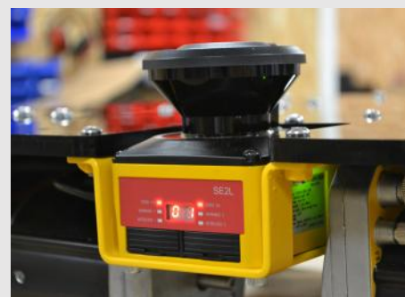
Skaner bezpieczeństwa SIL2 / PLd Kompatybilny ze wszystkimi laserowymi skanerami bezpieczeństwa dostępnymi na rynku
